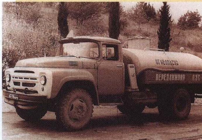
Передвижные АЭС (ПАЗС-3152) на шасси «ЗИЛ-130» с 1963 по 1980 годы изготавливались Гравовским заводом специализированных автомобилей. Этот экземпляр вырвался автомобилистов, оказавшихся с пустыми бензобаками на дорогах Крыма. Фото автора
