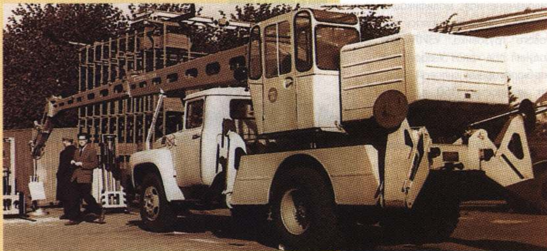
Гидравлический автомобильный кран «4056» на шасси «ЗИЛ-130» Львовского завода автопогрузчиков стал новой вехой в советском краностроении. Такие краны выпускались с 1964 по 1970 год. Фото автора
