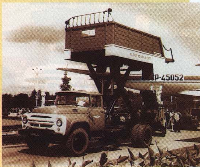
Автолифты для погрузки самолетов «АПК-9» на шасси «ЗИЛ-130 Г» выпускались с 1964 по 1970 год Опытным заводом № 85 ГВФ. Фото автора
