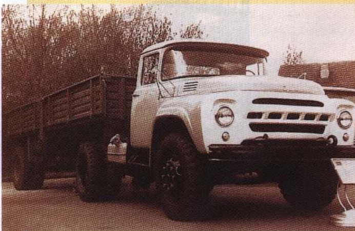
Седельный тягач «ЗИЛ-130 В1» с полуприцепом-платформой «ФдАЗ-885», 1962–1964 г.г. выпуска. Фото автора
