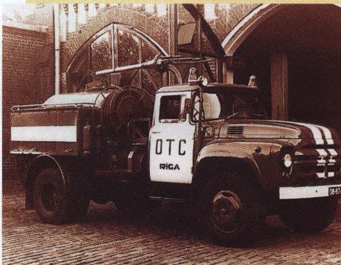
Пожарный автомобиль порошкового тушения «АП-2»(130). Модель «148» на шасси «ЗИЛ-130» Торжокского завода противопожарного оборудования 1974–1983 г.г. Фото автора
